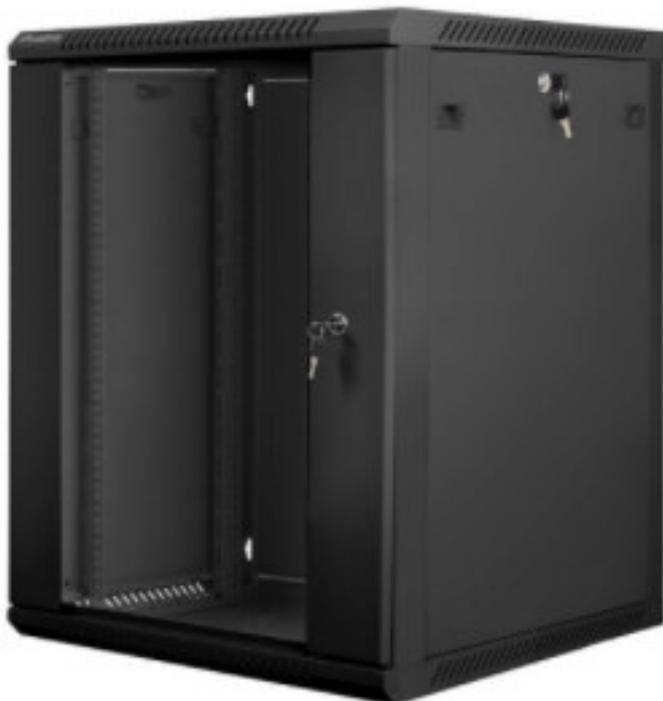
È prevista l'installazione di armadi rack 19", 15U o inferiori a seconda delle necessità specifiche, con dimensioni standard 600x600 mm completo di barra di alimentazione munita di interruttore e n.6 prese UNEL.
